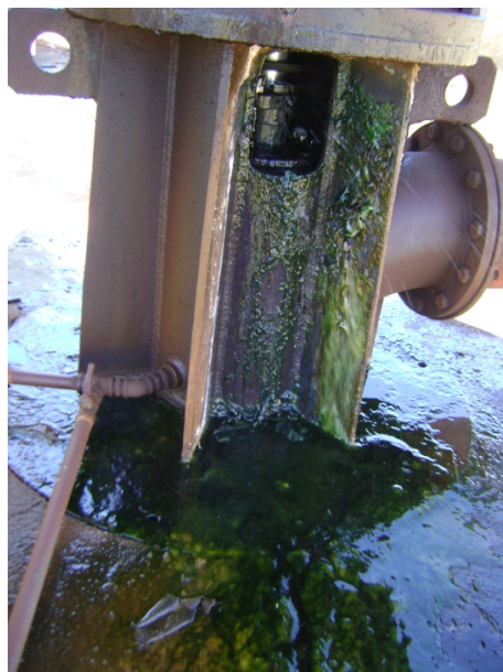
Figura 22: Vazamento Poço 001
